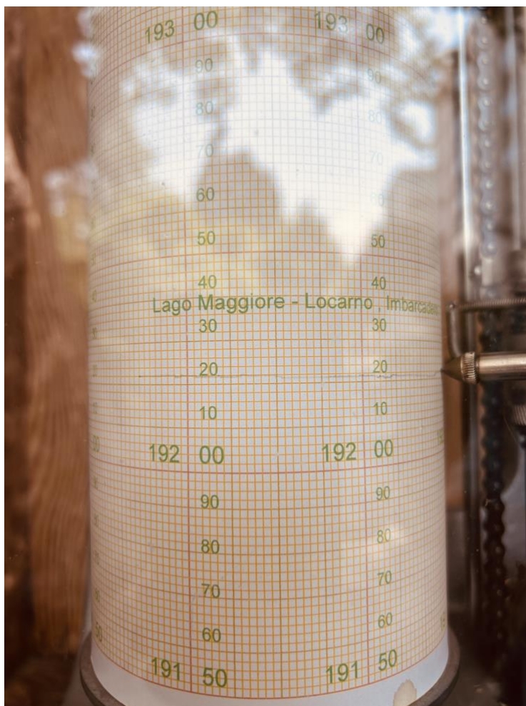
Il datario del limnigrafo: il 4 agosto alle ore 13:45 la punta di grafite marcava un'altezza di 192,22 m.
