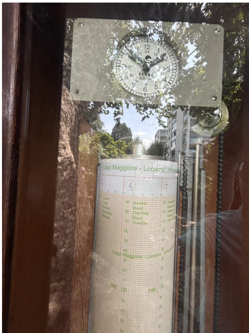
Il datario del limnigrafo: il quadrante segna le giornate (qui il passaggio tra il 3, il 4 e il 5 del mese) mentre il tamburo avanza registrando ora per ora il livello del lago.
