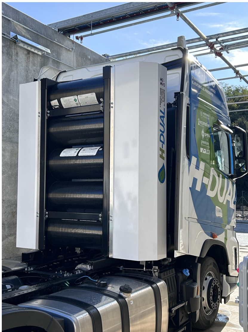
Fig. 6 – Le cinque bombole di idrogeno a 350 bar dietro la cabina.
