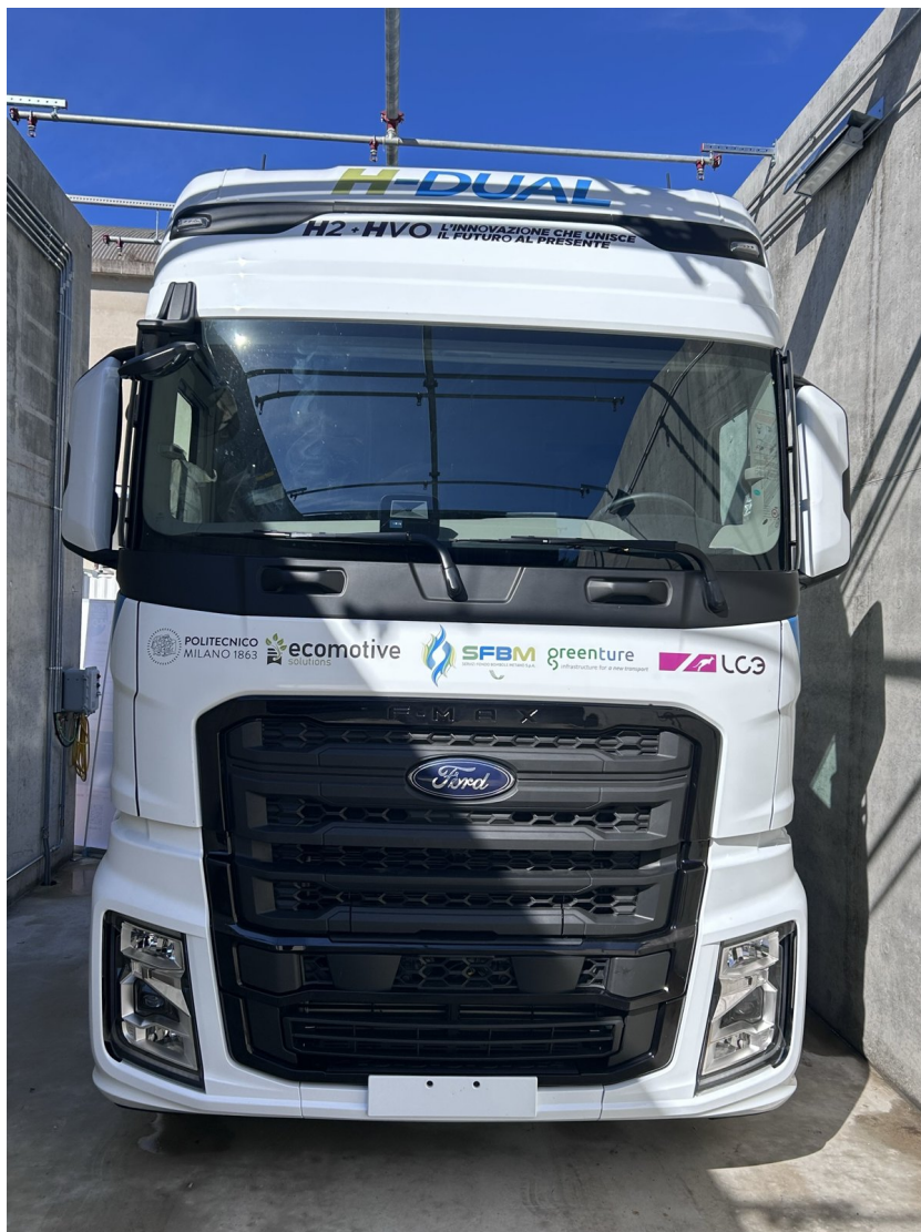
Fig. 5 – Il trattore Ford F-MAX H-DUAL (HVO + idrogeno).
